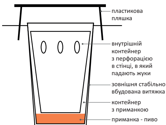
Рис. 1: Схема земляної пастки для живих тварин (за матеріалами роботи Pokluda (2008).
