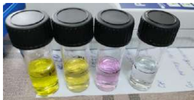
Фото 2. Ємності для тестів з дослідними зразками води та доданими реагентами Macherey-Nagel Visocolor Eco.
