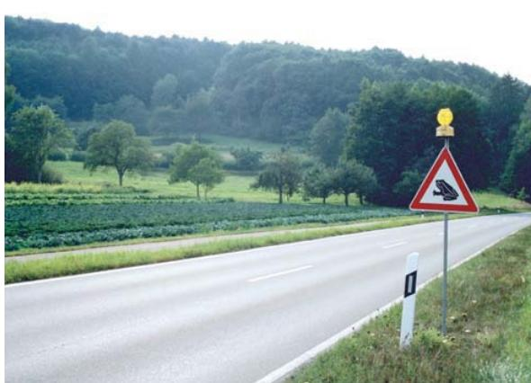
**Фото 63.** Попереджувальний знак про міграцію земноводних у поєднанні зі світлововою сигналізацією (Німеччина).
