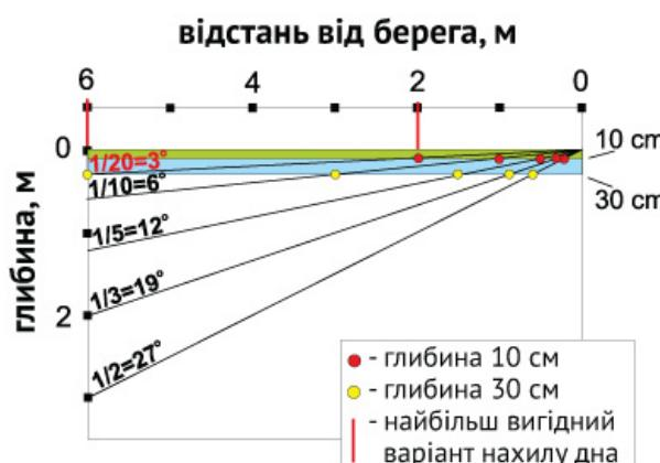
**Рисунок 46.** Профіль дна водойми та розміри зони мілководдя
